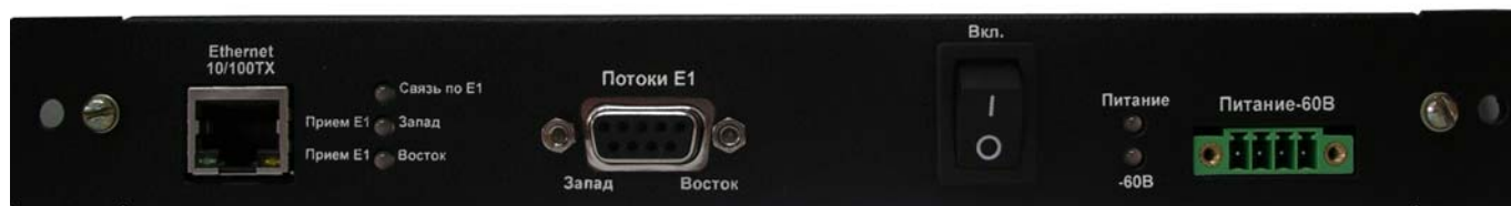
Рисунок 8.1. Полукомплект аппаратуры ЦВОЛТ «Гвоздь». Конвертер стыков (media-converter) Ethernet 100TX в Ethernet 100FX. Вид лицевой панели
