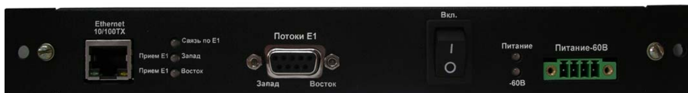
Рисунок 6.3 Полукомплект аппаратуры ЦВОЛТ «Гвоздь». Модуль передачи потока Ethernet 10Tx/100Tx по каналам потока E1. Вид лицевой панели.
