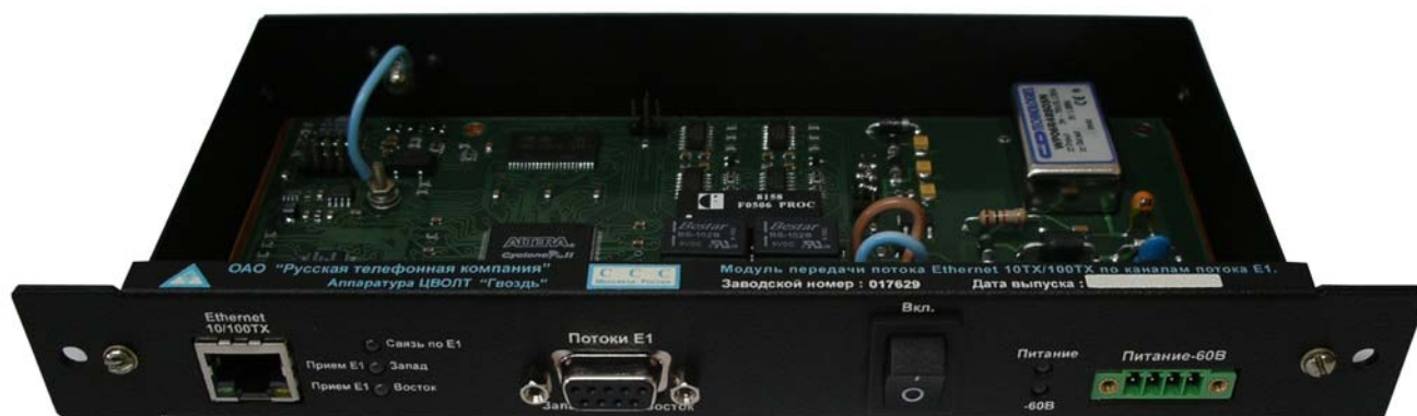
Рисунок 6.2 Полукомплект аппаратуры ЦВОЛТ «Гвоздь». Модуль передачи потока Ethernet 10Tx/100Tx по каналам потока E1. Вид изнутри.
