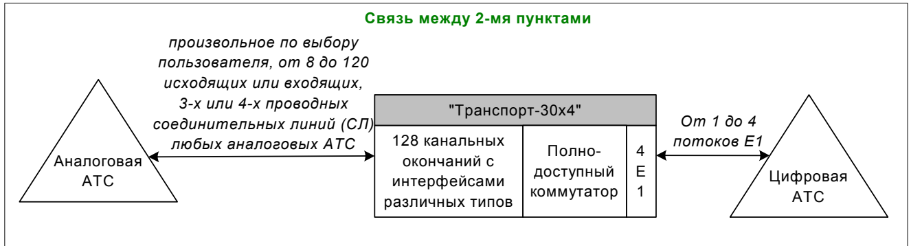
Рисунок 2.1 Организация соединительных линий аналоговых АТС с цифровыми АТС по трактам E1. Вариант 1
