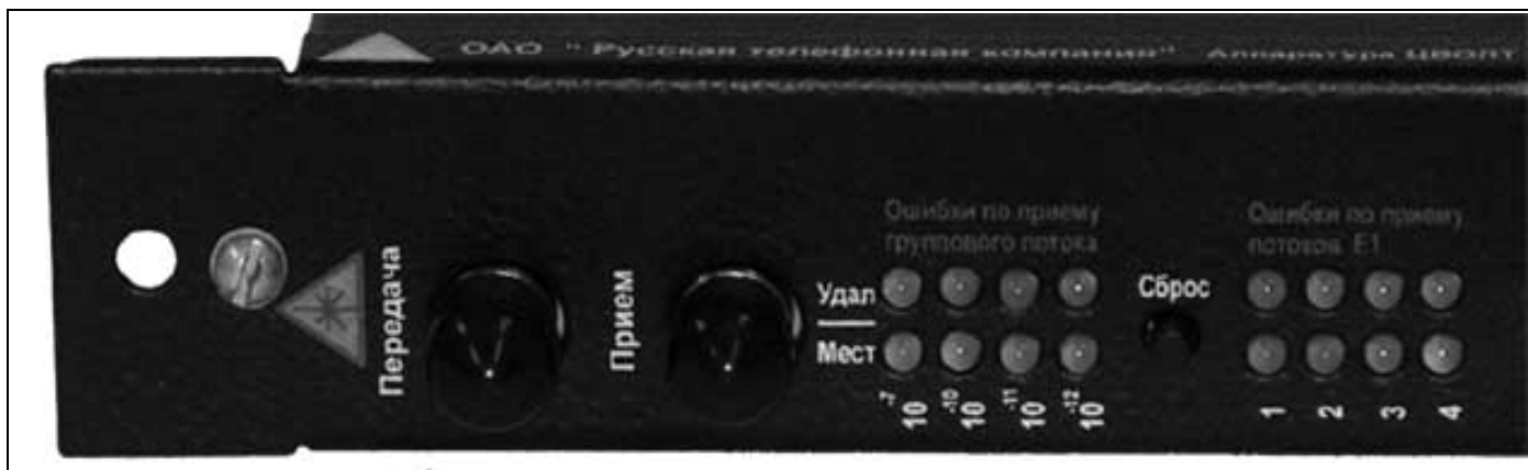
Фотография 6.2. Полукомплект аппаратуры ЦВОЛТ «Гвоздь». Индикация
