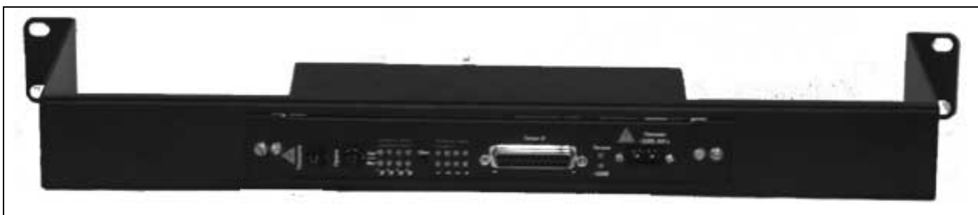
Фотография 6.7. Установка полукомплекта в одноместной универсальной крепёжной пластине для крепления на стенах здания. Вид спереди.
