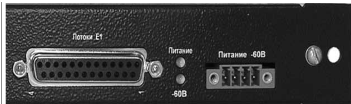
Фотография 6.3. Полукомплект аппаратуры ЦВОЛТ «Гвоздь». Вид разъемов на панели
