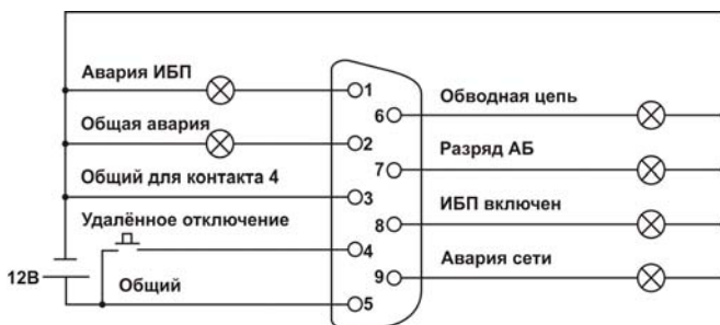
Рисунок 9 – Электрическая схема организации контроля и управления ИБП с электропитанием от источника постоянного тока напряжением +12 В
