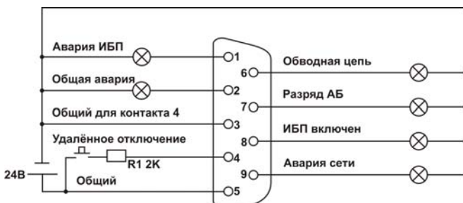
Рисунок 8 – Электрическая схема организации контроля и управления ИБП с электропитанием от источника постоянного тока напряжением +24 В
