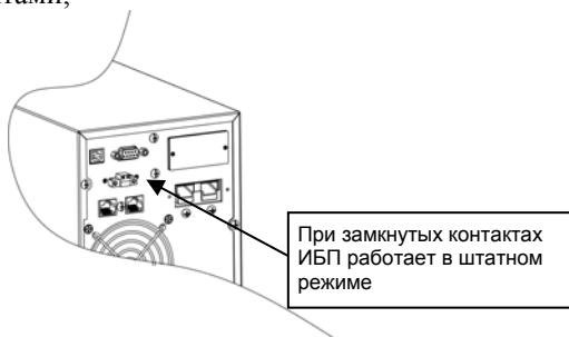
Рисунок 6 – Внешний вид порта дистанционного аварийного отключения (EPO), расположенного на задней панели ИБП
