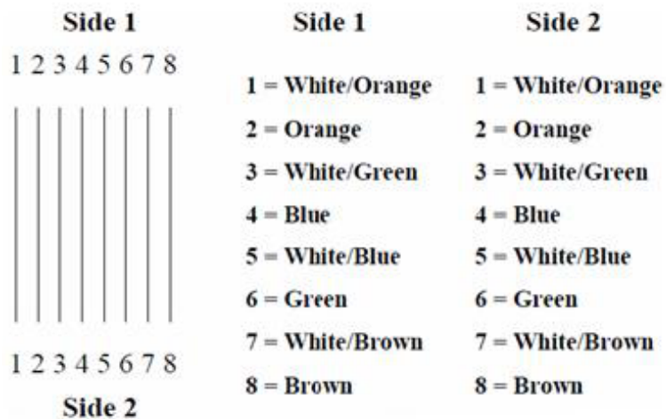
Рисунок 4 – Прямой кабель для Ethernet.
